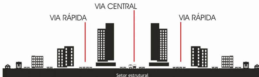
Figura 1: Corte transversal - Sistema Trinário
