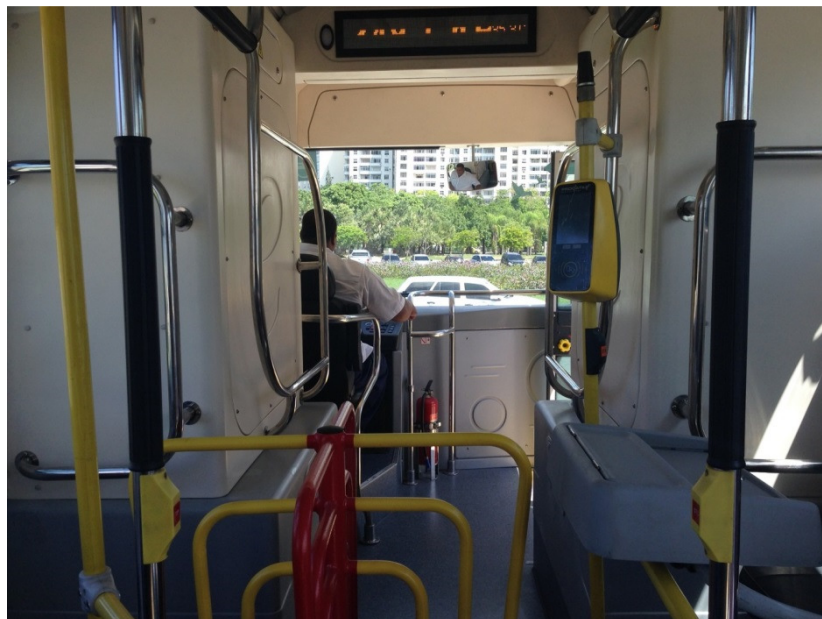
Figura 2 – Disposição interna do validador, cobrador e roleta no interior do ônibus elétrico
