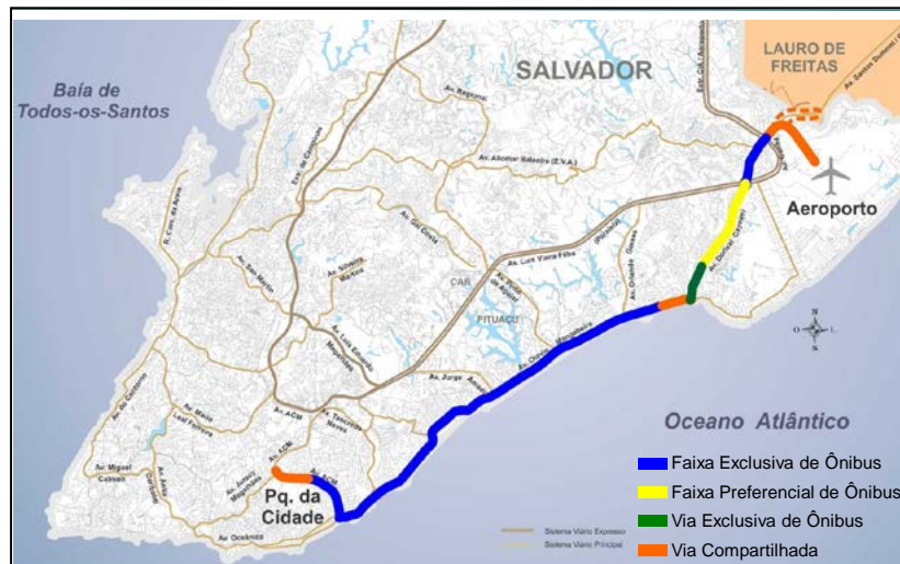
Figura 07 - Corredor Aeroporto-Pituba – tipos de tratamento físico
