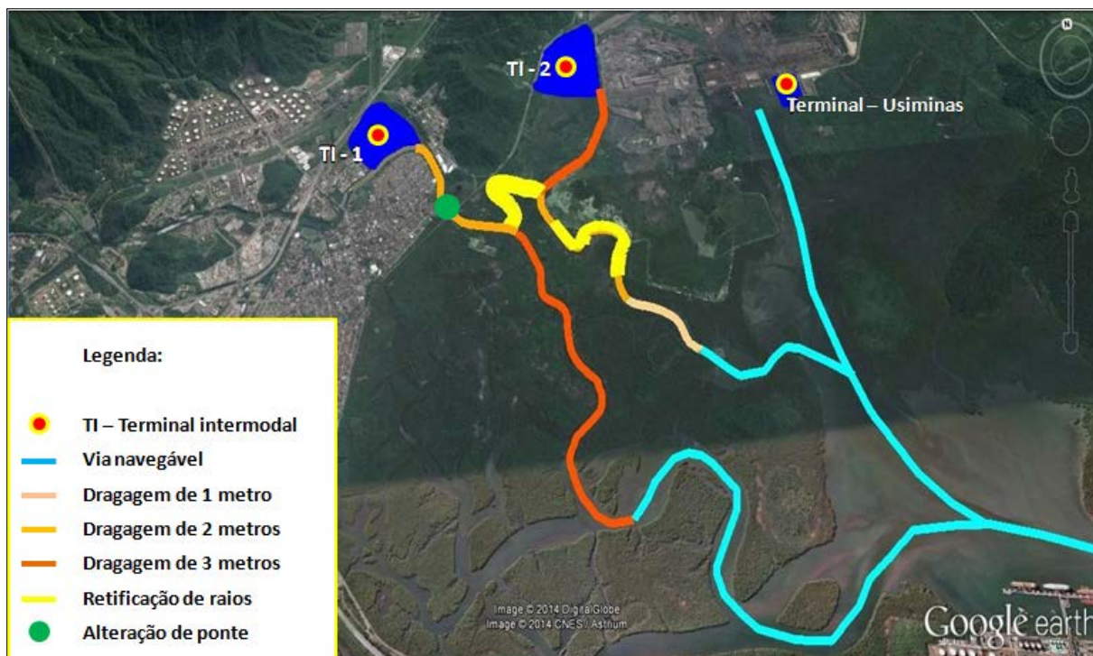
Figura 8 - Identificação das intervenções necessárias para viabilizar o acesso aos Terminais T-1, T-2 e Usiminas.
