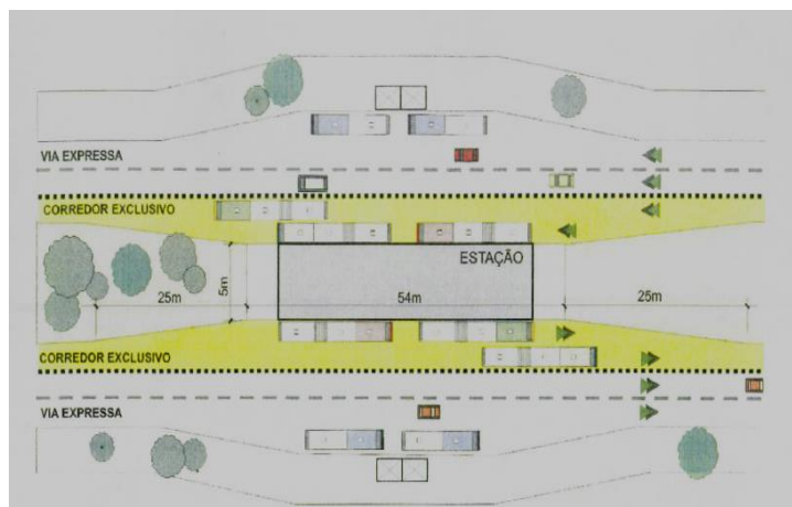
Figura 2.3: Corredor Viário com Possibilidade de Ultrapassagem: Estação Park Way do BRT-SUL
